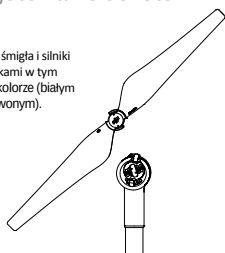
Przyciśnij silnik oraz obróć blokadę śmigła, aż strzałki zrównają się i usłyszysz kliknięcie.
